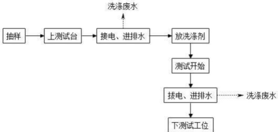
图2.4-7 检测工艺流程图
