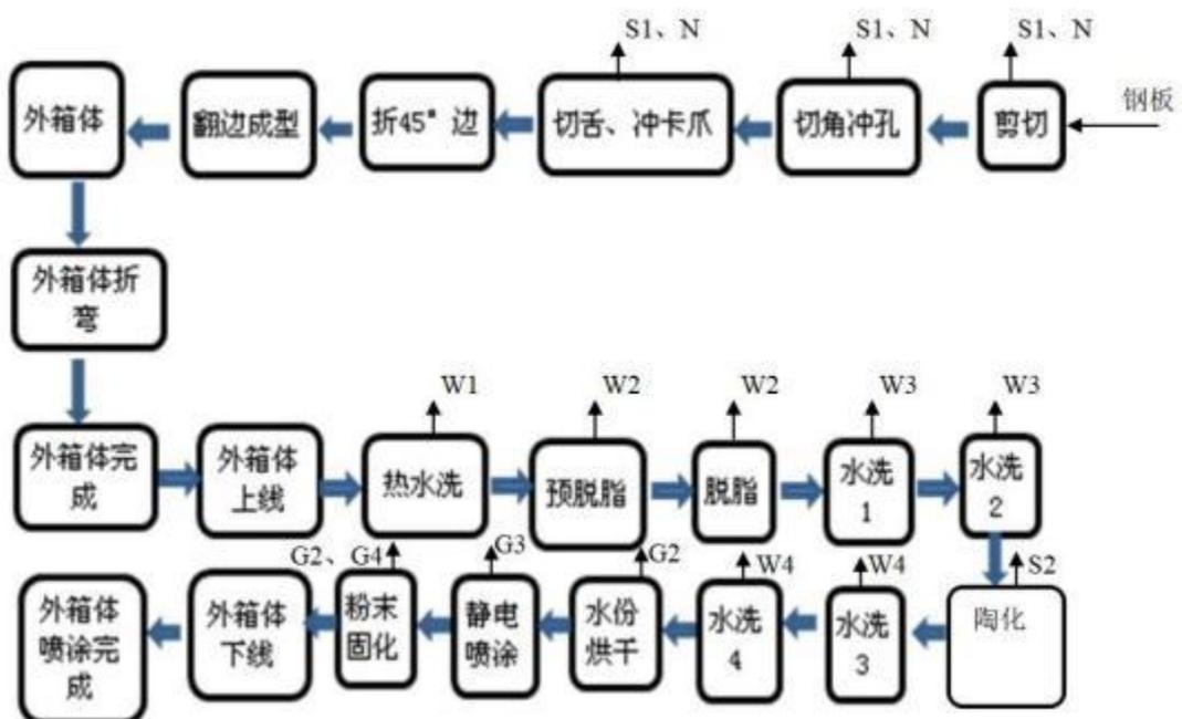
图 2.4-4 微波炉外箱体工艺流程图
