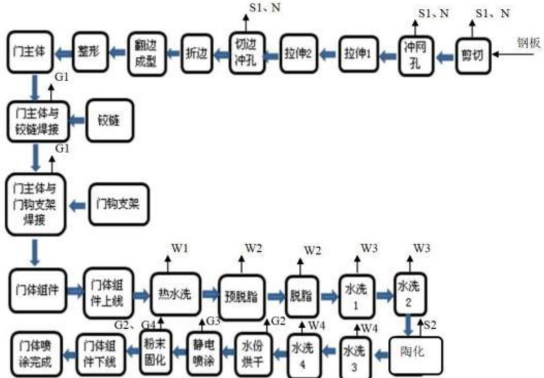
图2.4-3 微波炉门体组件工艺流程图
