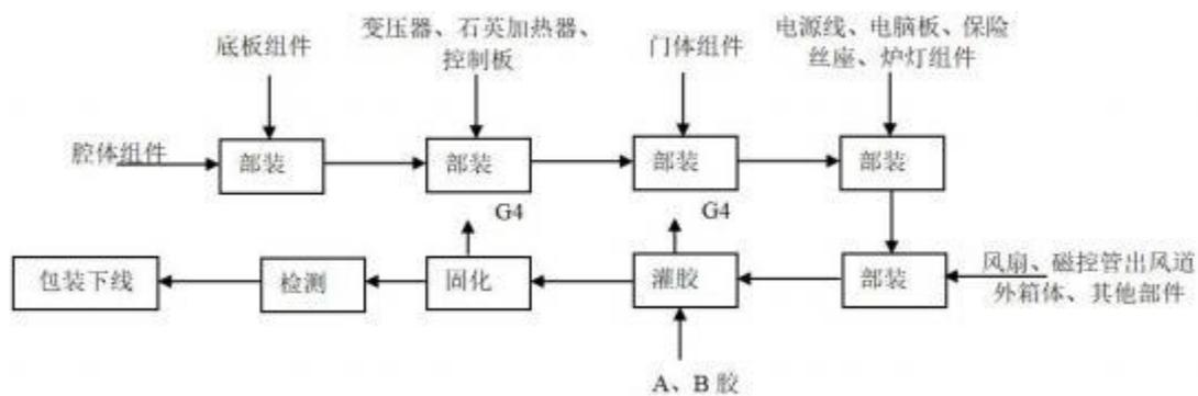
图 2.4-5 微波炉总装工艺流程图
