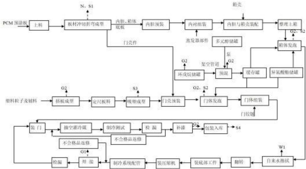
图 2.4-1 冰箱工艺流程图
