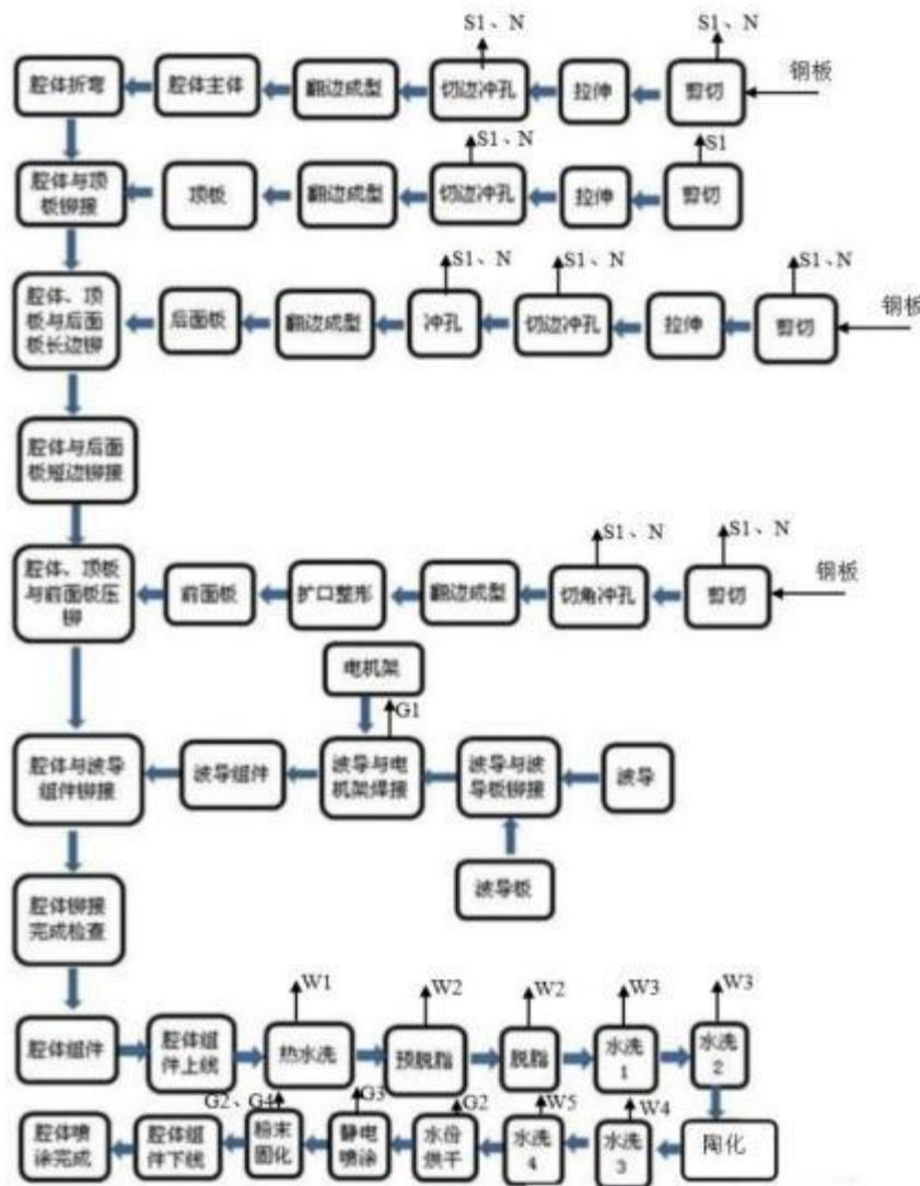
图 2.4-2 微波炉腔体组件工艺流程图
